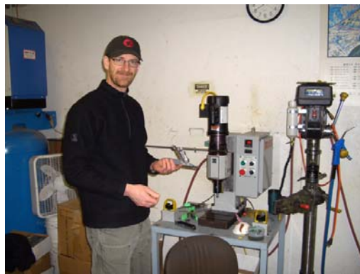
バインディングのリベットを打つ機械。
